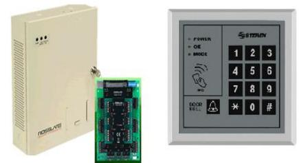
En los equipos de mayor calidad el controlador es un equipo físicamente independiente, pero en soluciones económicas se suele integrar el controlador y dispositivos de entrada.
